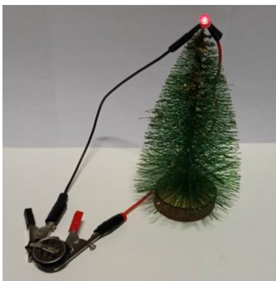
Рис. 94. Демонстрация работы электрохимической ячейки с электродом на основе тройной системы \text{Mn}_x\text{O}_y/(\text{графен}-\text{CeO}_2)
