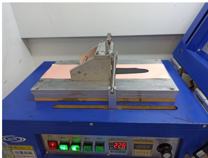
Рис. 32. Нанесение электродной смеси на медную фольгу с помощью инструмента для ракельного нанесения Dr. Blade
